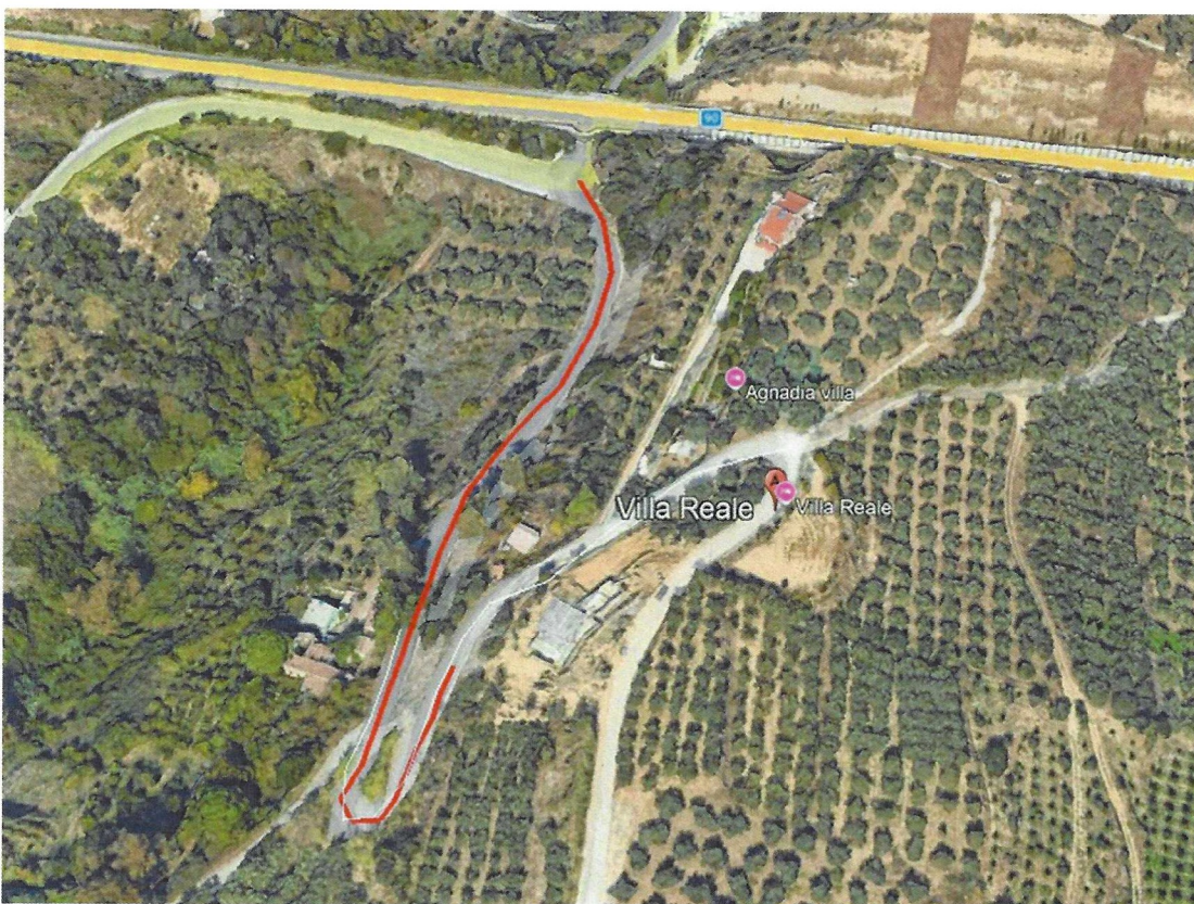
Πάνω Σταλός, αγωγός ονομ. διαμέτρου DN 90 mm 16 atm συνολικού μήκους 300 μ
